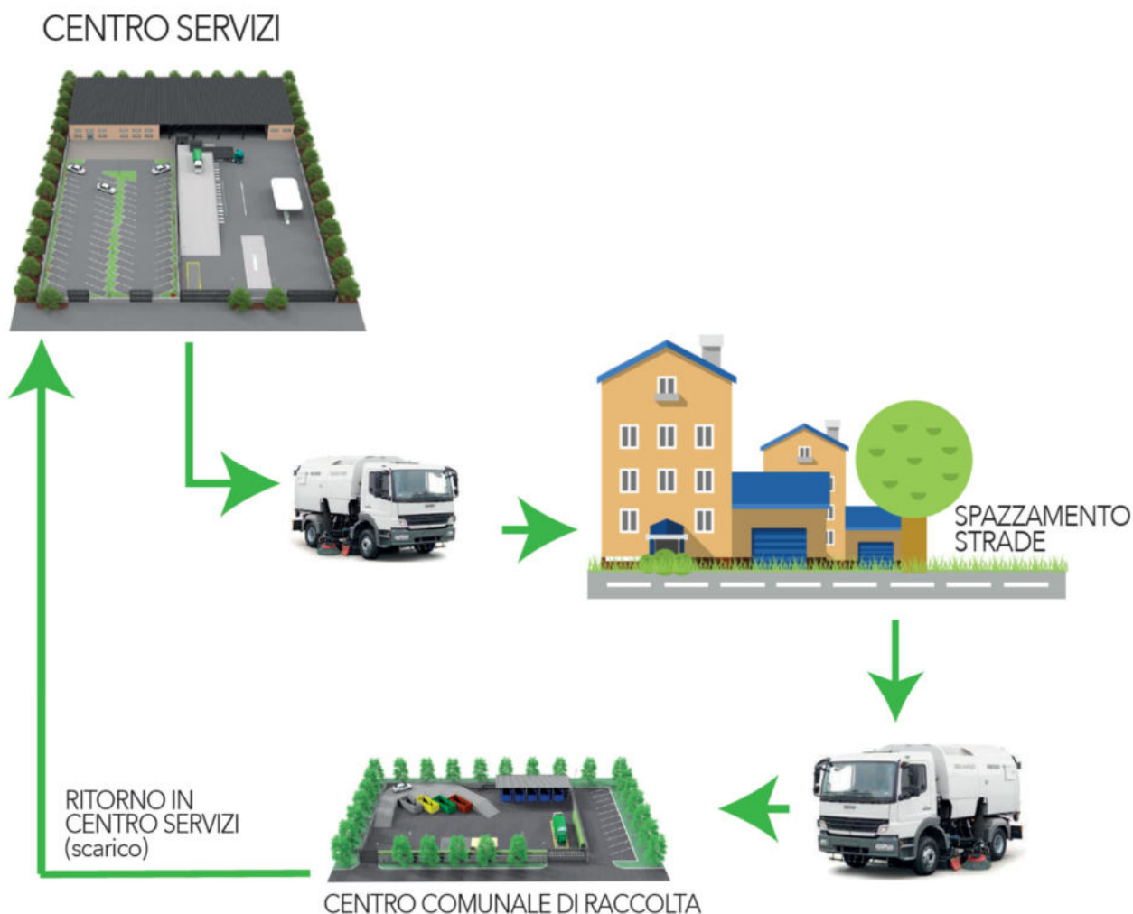
Figura 40: Rappresentazione grafica di una modalità operativa di spazzamento stradale
