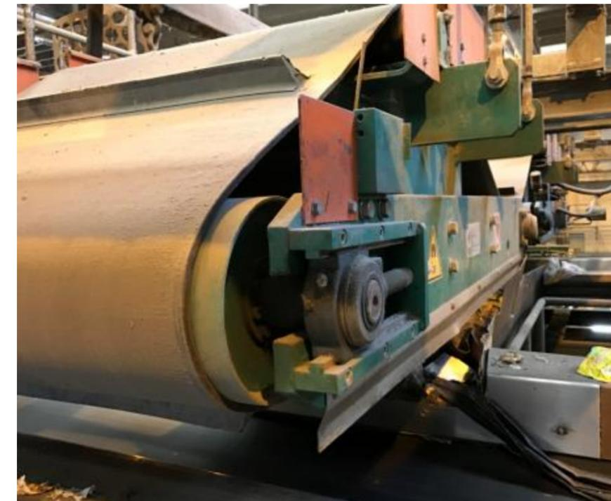
Figura 117 - elettrocalamite sopravaglio primario
