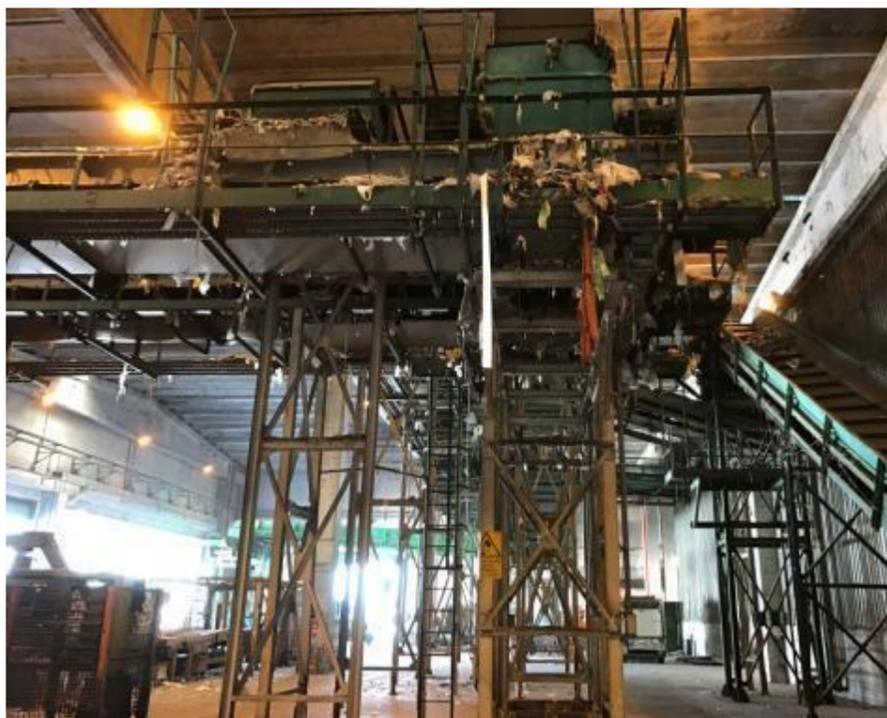
Figura 138 - nastro di carico presse
