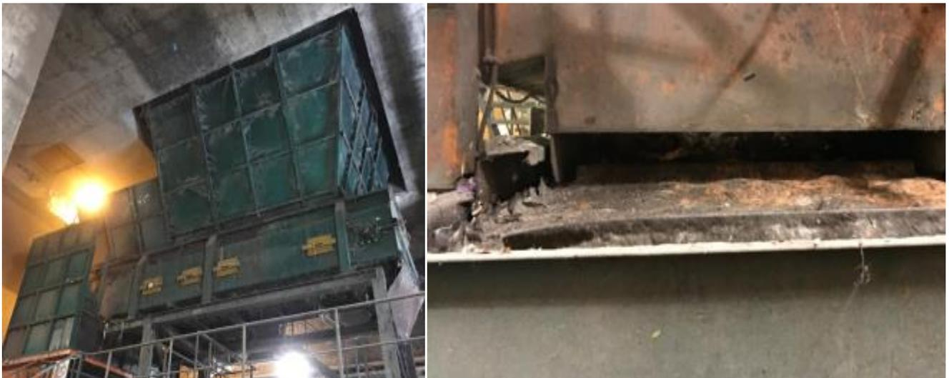
Figura 22 - Tramoggia di carico e usura del nastro metallico
